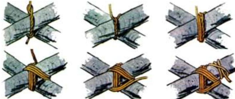
Le brelage droit ou carré est une méthode d'assemblage de deux perches devant se croiser perpendiculairement (convient dans la plupart des cas).
