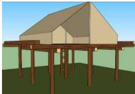
Pour commencer, il faut savoir que la tente a une base de 4m sur 4m. Dès lors, la structure doit au minimum avoir les mêmes dimensions. Commencez donc par construire trois structures en « E » avec la perche horizontale mesurant 4,5m (ça dépassera un peu) et des verticales de 2,5m (40cm dans le sol et +/- 1,9m de hauteur sous la structure). Ces dimensions permettent d'avoir un espace utilisable sous le pilotis. Aménagez-le comme vous le souhaitez une fois le pilotis fini.
